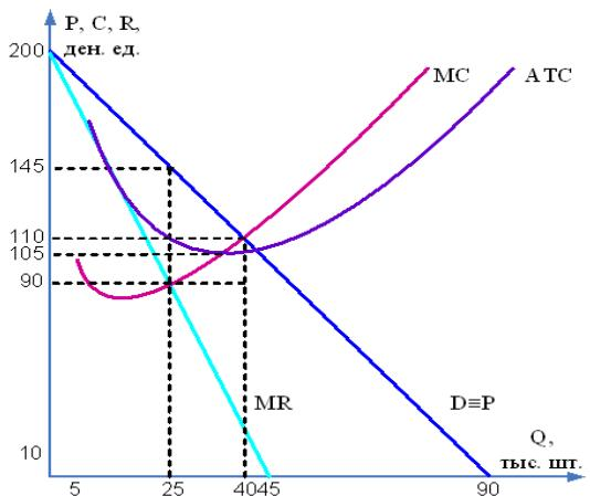
и предельных издержек (MC) имеют следующий вид:  $MR = 200 - 2Q$ ,  $MC = 3Q$ , где  $Q$  – объем производства, в ед.
